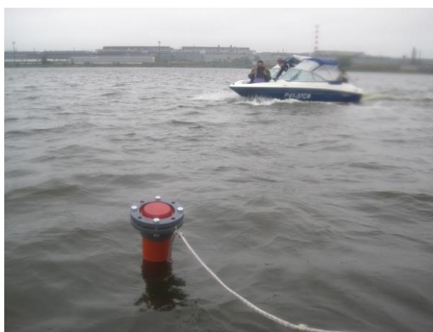
Рис. 1. Фото исследовательского волнового буя на испытаниях
